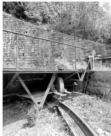
Système de roulement et leviers de blocage.
