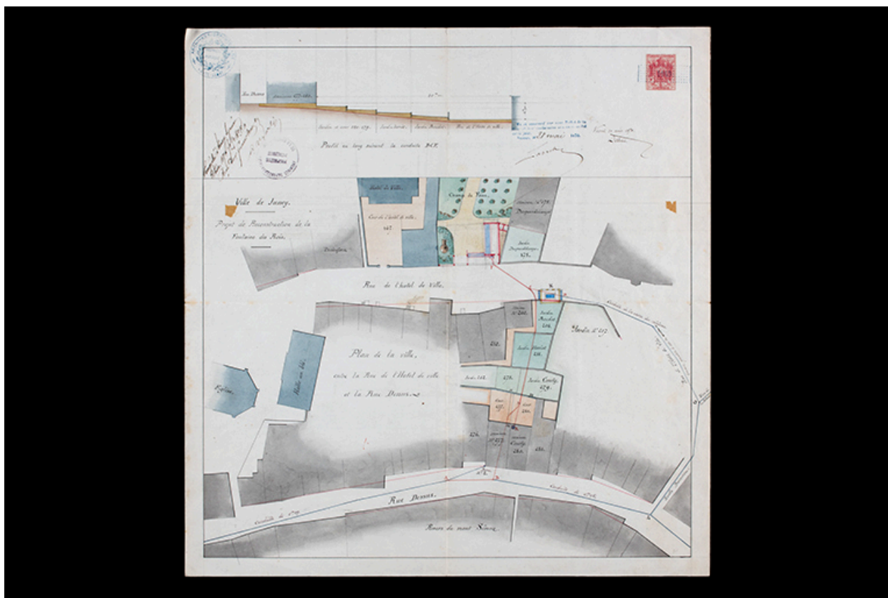
Plan projeté de l'adduction en eau de la fontaine-lavoir des Rois de jussey, 30 avril 1870.
