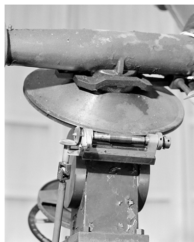
Système de rotation : engrenages, vis sans fin et disque denté. Phot. Yves Sancey IVR43_20032501145X
