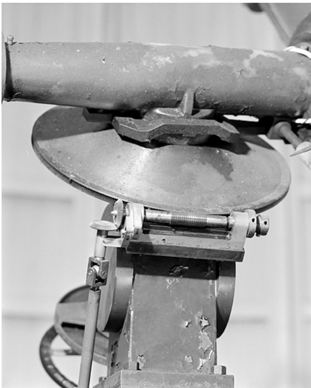
Système de rotation : engrenages, vis sans fin et disque denté.
