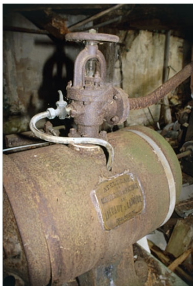
Machine à vapeur : le cylindre. Phot. Yves Sancey IVR43_20009000376ZA
