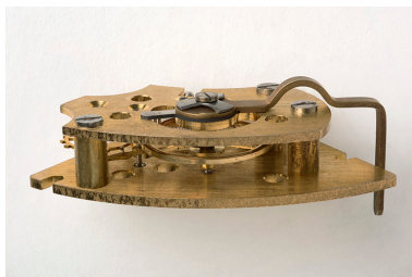
Vue d'ensemble plongeante, côté platine supérieure. Système de réglage de l'avance/retard (raquette) au-dessus, roue d'ancre à gauche et balancier au centre en dessous. Phot. Sonia Dourlot IVR43_20152502582NUC4A
