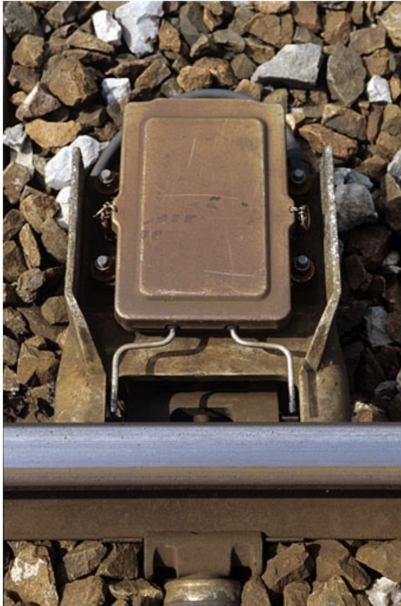
Pédale électromécanique Forfex : vue rapprochée.
