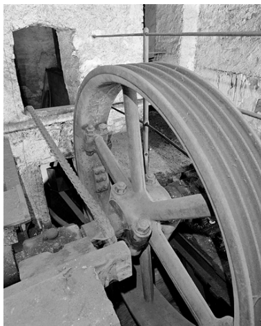
Détail de la roue de transmission de la machine à vapeur. Les gorges de la roue accueillaienl des câbles en chanvre de section carrée (l'un d'eux est visible contre l'axe de la roue). Phot. Yves Sancey IVR43_19999000243X
