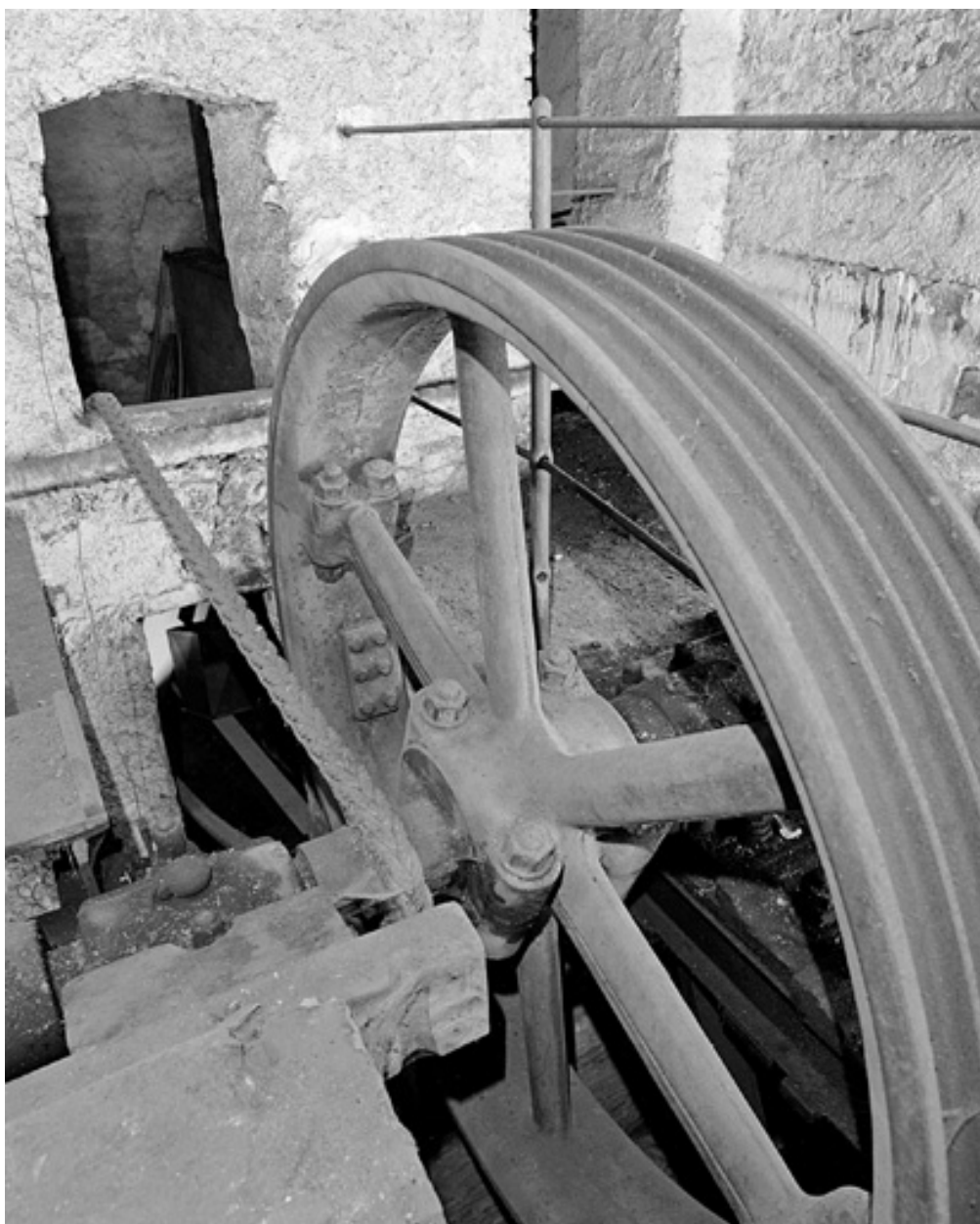
Détail de la roue de transmission de la machine à vapeur. Les gorges de la roue accueillaient des câbles en chanvre de section carrée (l'un d'eux est visible contre l'axe de la roue).
