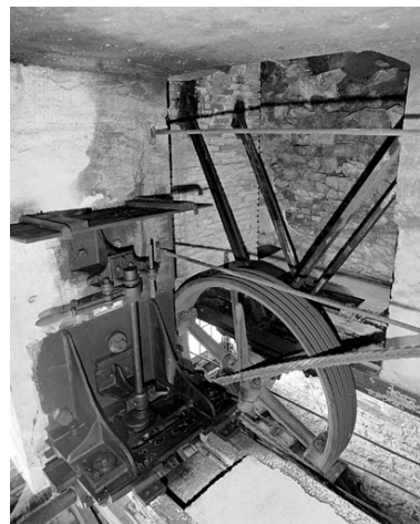
Roue de transmission de la machine à vapeur et système de couplage de la turbine. Phot. Yves Sancey IVR43_19999000239X
