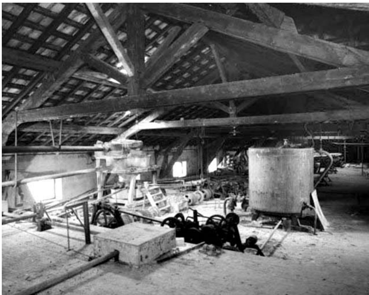
Cuve, système de distribution de la noria et systèmes de descente des châssis multilames dans le comble.
