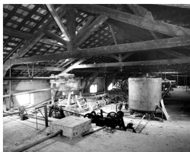
Cuve, système de distribution de la noria et systèmes de descente des châssis multilames dans le comble. Phot. Yves Sancey IVR43_19933900261X
