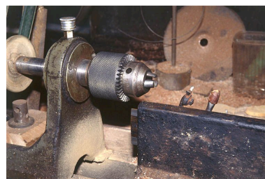
Détail de la machine équipée d'un mandrin de perceuse. Phot. Jérôme Mongreville IVR43_20003901289ZA
