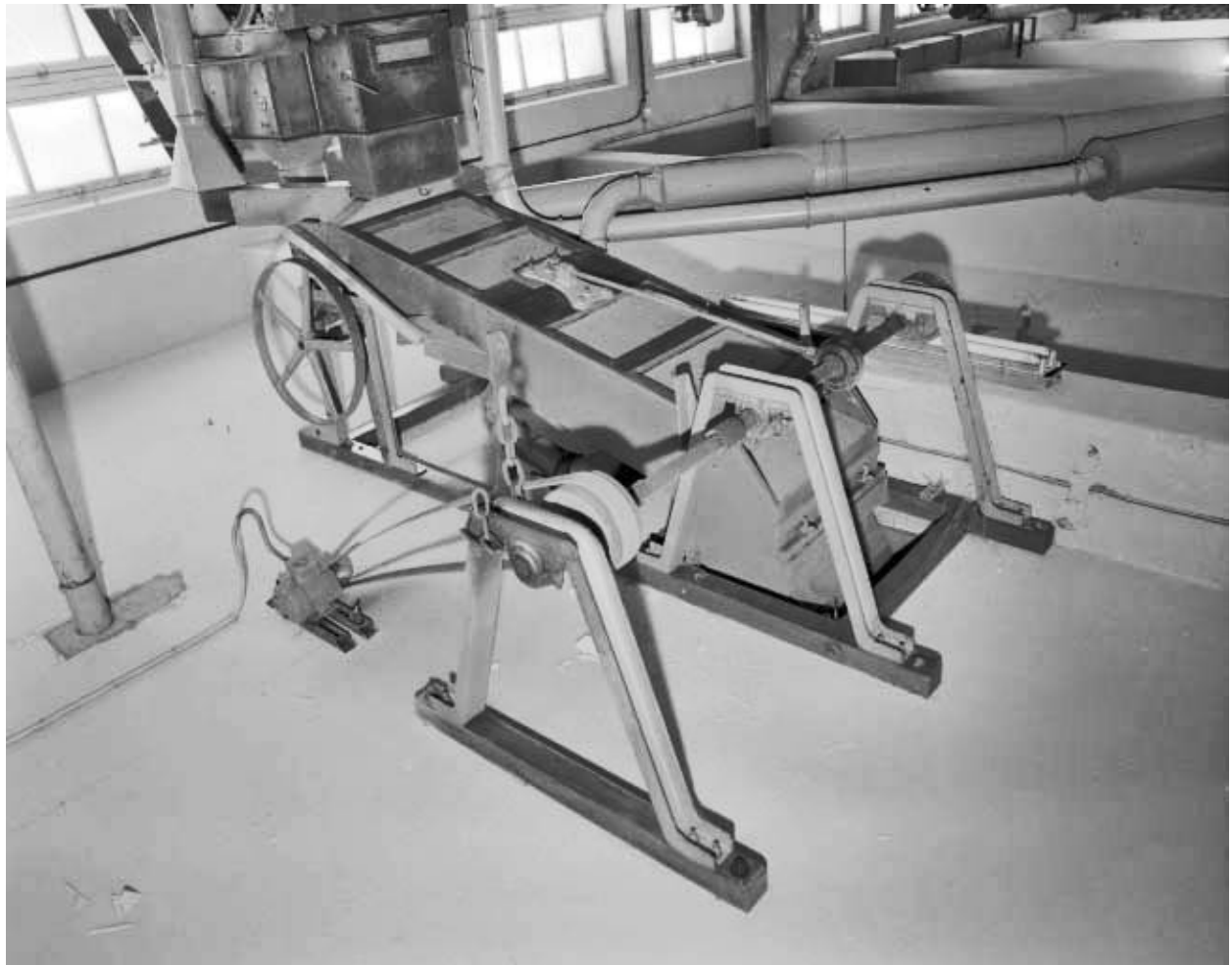
Trémie d'alimentation et distributeur vibrant.
