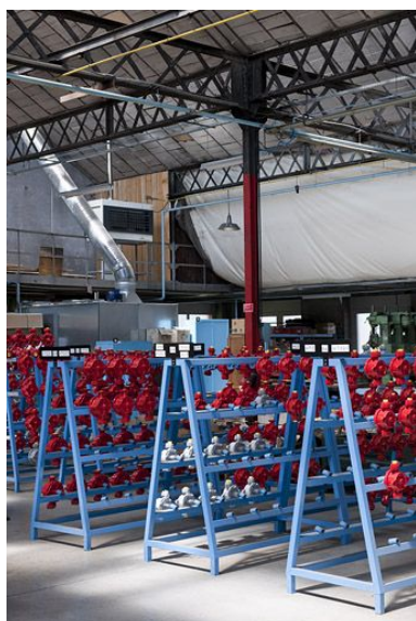
Atelier de fabrication. Portiques de séchage des corps de pompes. Phot. Jérôme Mongreville IVR43_20112501190NUC4A
