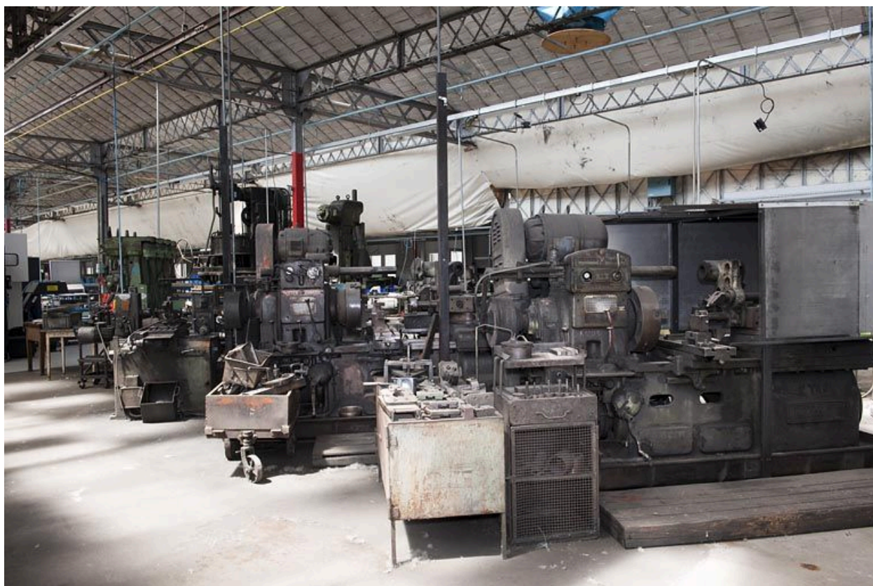
Machine double à fraiser Somua et tours horizontaux américains Potter et Johnston (hors-service).
