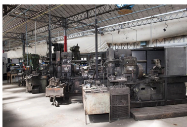
Machine double à fraiser Somua et tours horizontaux américains Potter et Johnston (hors-service). Phot. Jérôme Mongreville IVR43_20112501194NUC4A
