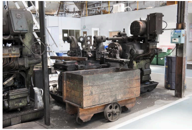
Chariot de transport et tour horizontal américain Potter et Johnston. Phot. Jérôme Mongreville IVR43_20112501191NUC4A
