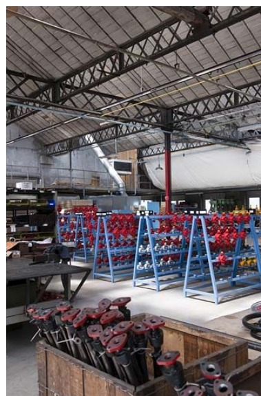
Atelier de fabrication. Corps de pompes en cours de séchage. Phot. Jérôme Mongreville IVR43_20112501189NUC4A
