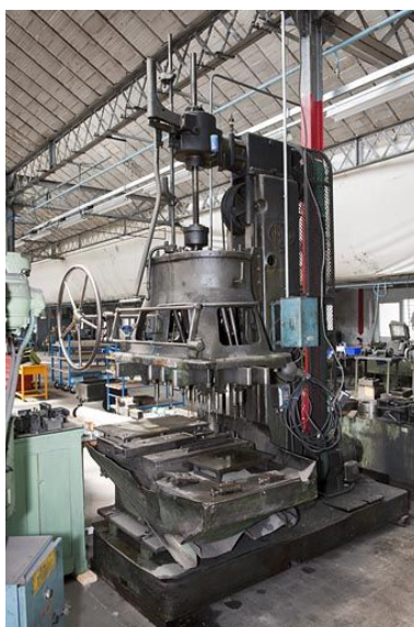
Machine multiple à percer Natco. Phot. Jérôme Mongreville IVR43_20112501197NUC4A
