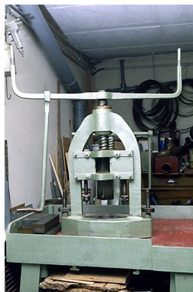
Machine à découper par poinçon ; machine à emboutir ; machine à estamper. Phot. Jérôme Mongreville IVR43_20003901139ZA
