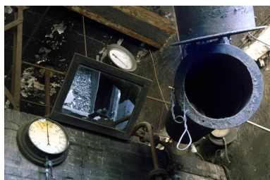
Détail de la partie haute de la chaudière (1927). A droite : tuyau articulé de chargement de la trémie. Phot. Yves Sancey IVR43_19999000237ZA
