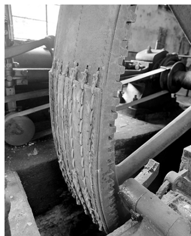
Détail du volant de transmission et de la courroie en cuir. Phot. Yves Sancey IVR43_19999000230X
