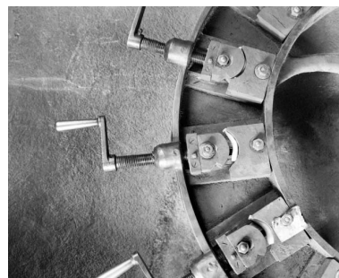
Détail de la machine à cintrer les tuyaux en corne. Phot. Jérôme Mongreville IVR43_19923900508X
