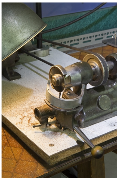
Lame et système de positionnement de la pièce. Phot. Yves Sancey IVR43_20103900292NUC2A
