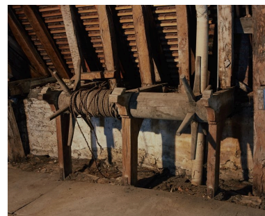
Salle de spectacle en 1996 : mécanisme du lustre (dans le comble). Ce mécanisme a été supprimé après 1996. Phot. Michel Rosso IVR26_19962100770XA
