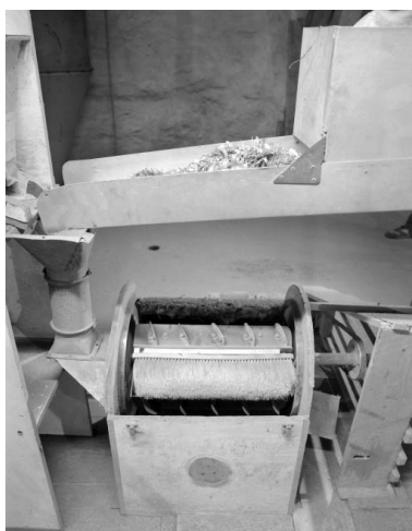
Vue plongeante. Le démontage de la paroi supérieure laisse apparaître les broches (fibres végétales). Phot. Jérôme Mongreville IVR43_19973900315X
