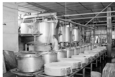
Intérieur de l'atelier de fabrication, à l'étage. Presses au premier plan, 3 cuves de 8000 l. à gauche. Phot. Laurent Poupard IVR43_19883900233Z
