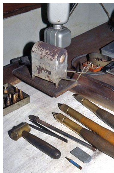
Four à résistance Portius. De gauche à droite, marteau pour désaxer la poupée fixe du tour, pince pour tenir le diamant, bâtons destinés à porter le second diamant. En haut à gauche, mandrins pour la fixation du diamant sur le tour.
