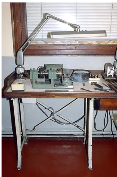
Vue d'ensemble d'une machine à débruter et de son four à résistance. Phot. Jérôme Mongreville IVR43_20013900016ZA
