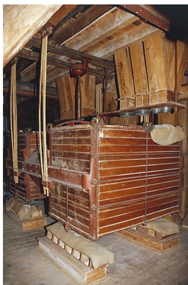
Plansichter Lafon à l'étage en surcroît.
