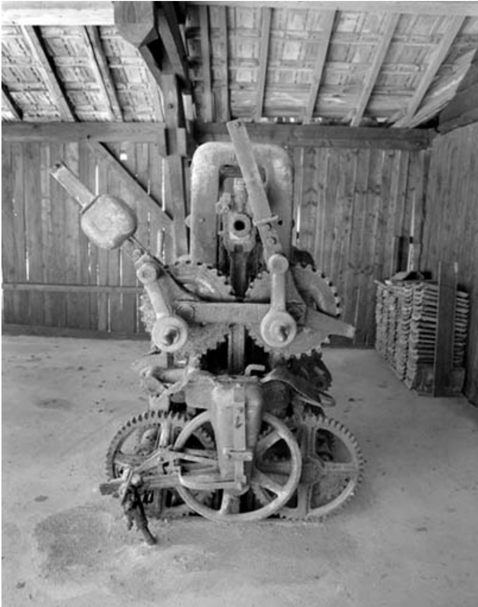
Scie à lames multiples vue de côté.
