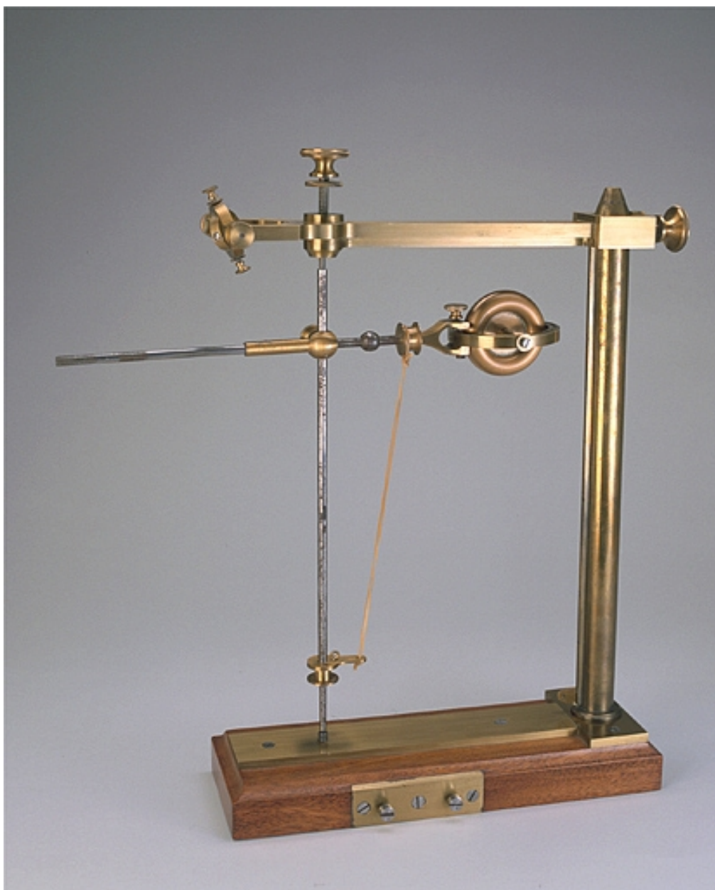
Montage : tourniquet alternatif à tension de M. Gruey.
