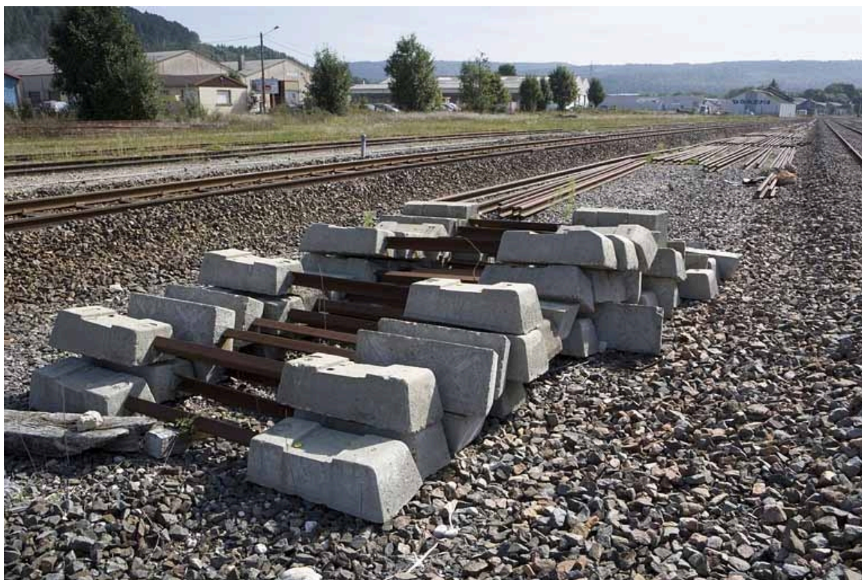
Vue d'ensemble de traverses Stradal, en gare de Champagnole.
