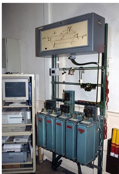
Vue d'ensemble, de trois quarts droite. Le tableau de contrôle optique surmonte les commutateurs. A gauche, ordinateur
