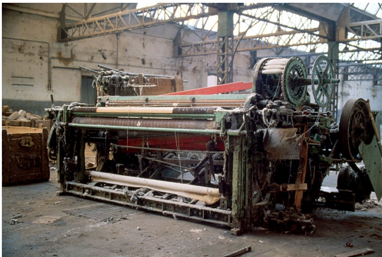
Face avant du métier à tisser. Les cannettes, dans le barillet surmontant le métier, étaient fabriquées à l'usine.
