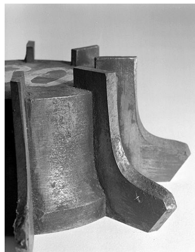
Détail d'une fraise, montrant le profil des fers. Phot. Jérôme Mongreville IVR43_20003900981X
