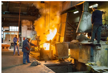
Bascule d'un four à induction dans une poche. Phot. Jérôme Mongreville IVR43_20132500955NUC4A
