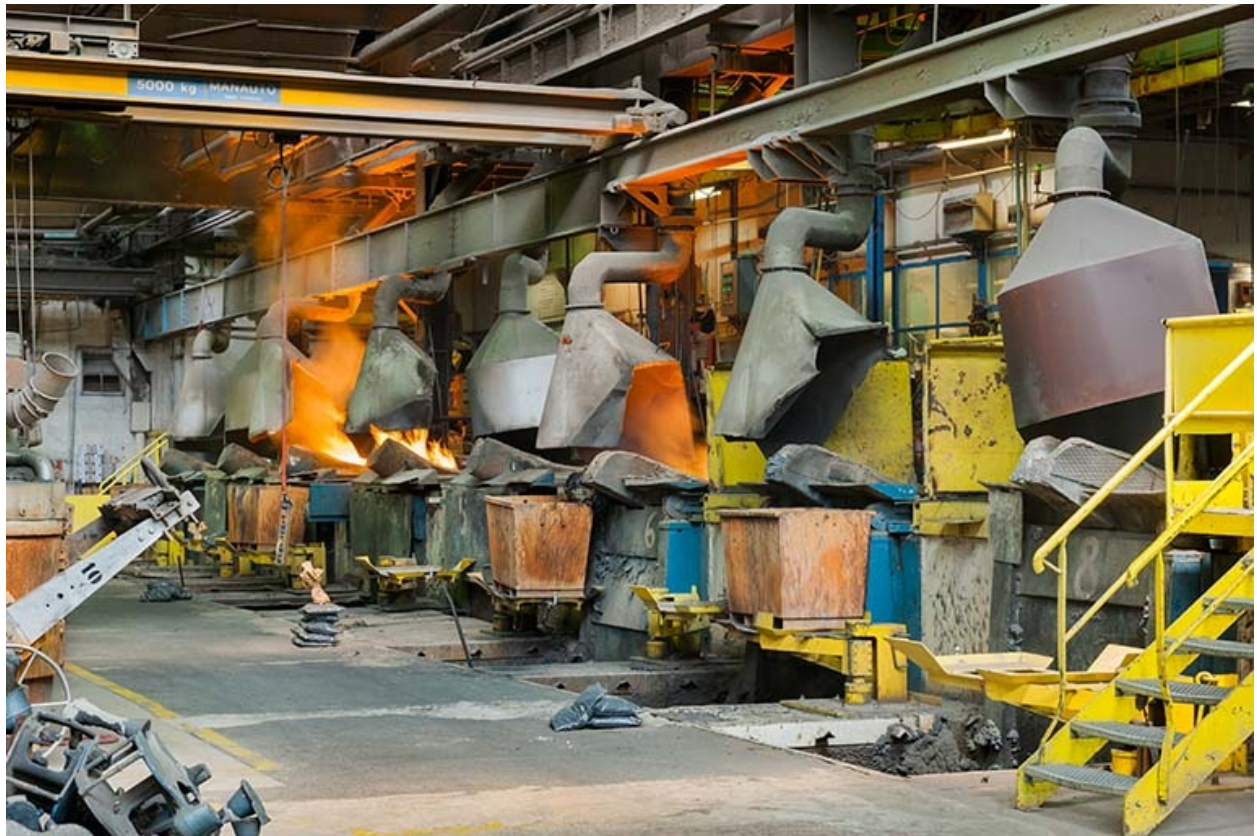
Batterie de fours à induction (3).
