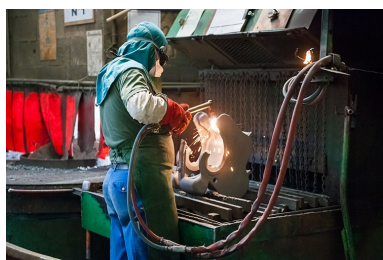
Découpage de pièces au chalumeau (3). Phot. Jérôme Mongreville IVR43_20132500971NUC4A
