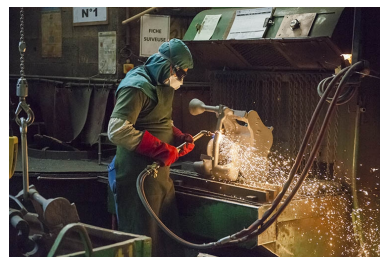
Découpage de pièces au chalumeau (2).
