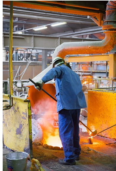
Prélèvement de matière en fusion dans un four à induction (2). Phot. Jérôme Mongreville IVR43_20132500958NUC4A
