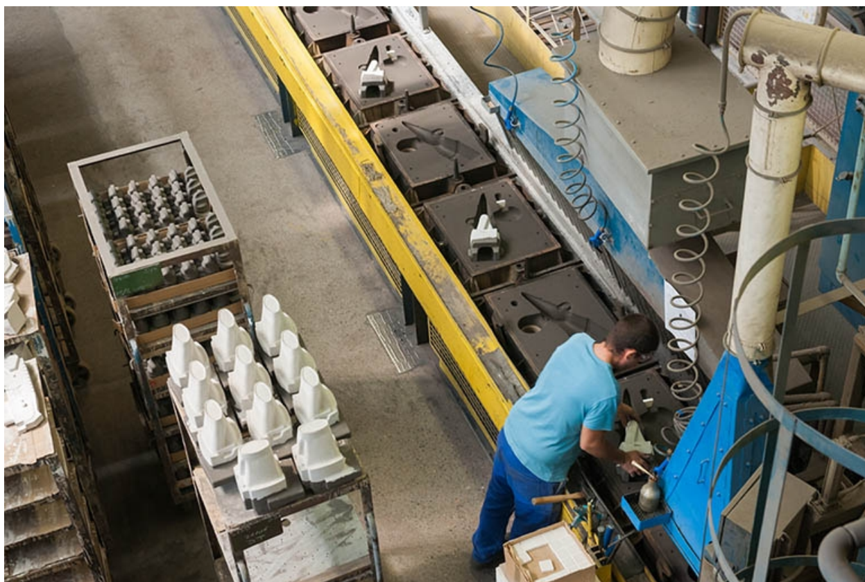
Montage des moules (1).
