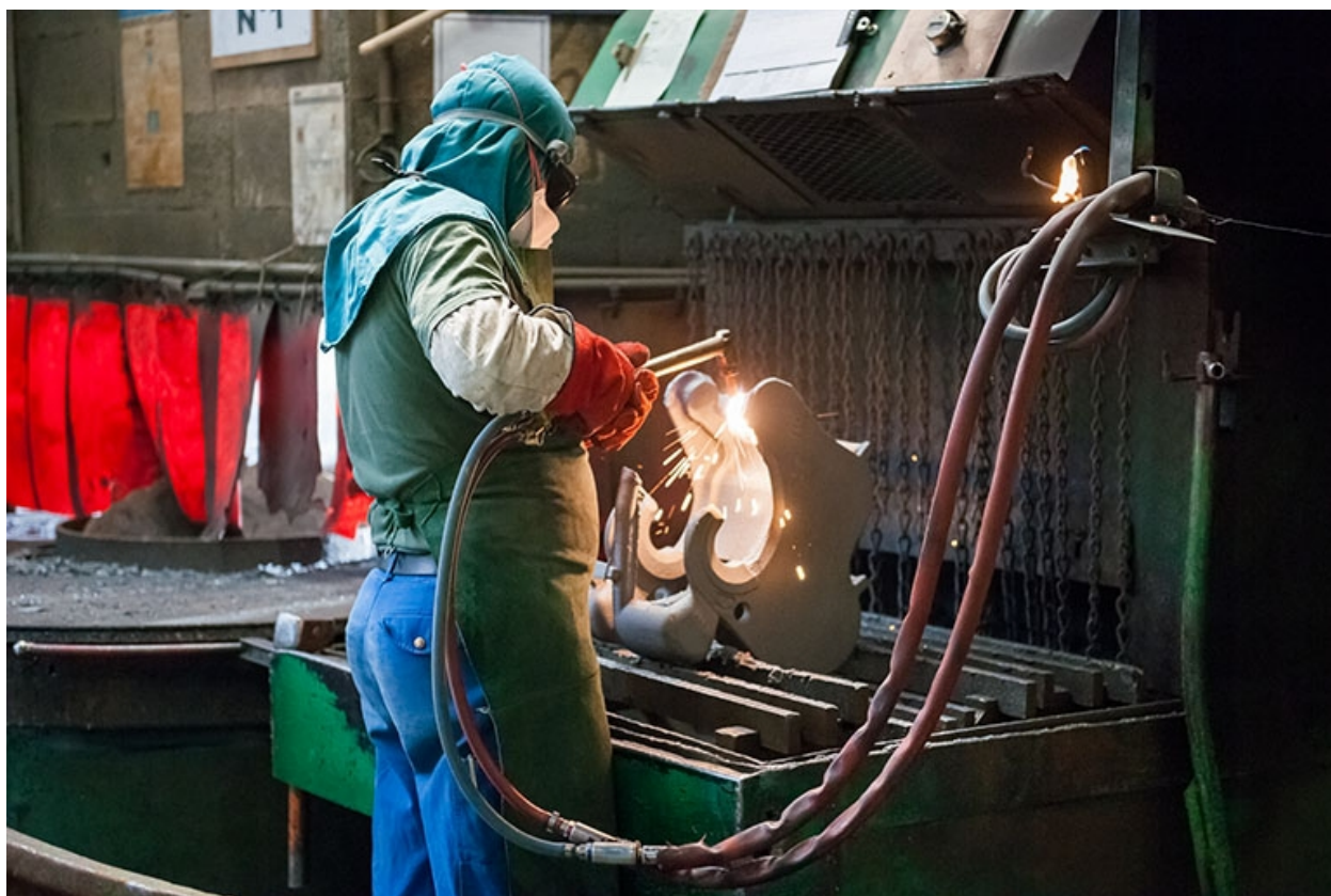
Découpage de pièces au chalumeau (3).
