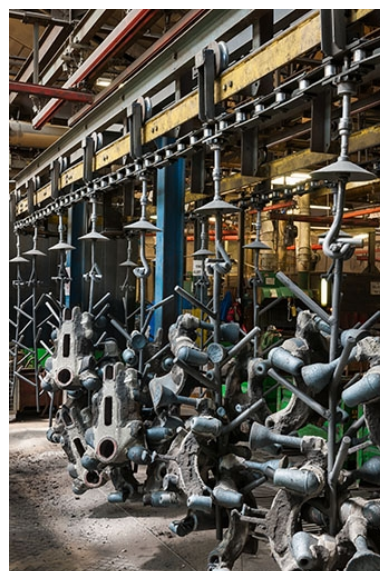
Pièces au dessablage (grenailleuse). Phot. Jérôme Mongreville IVR43_20132500981NUC4A
