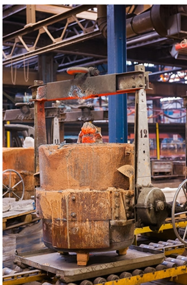
Poches de coulée avant réfection.
