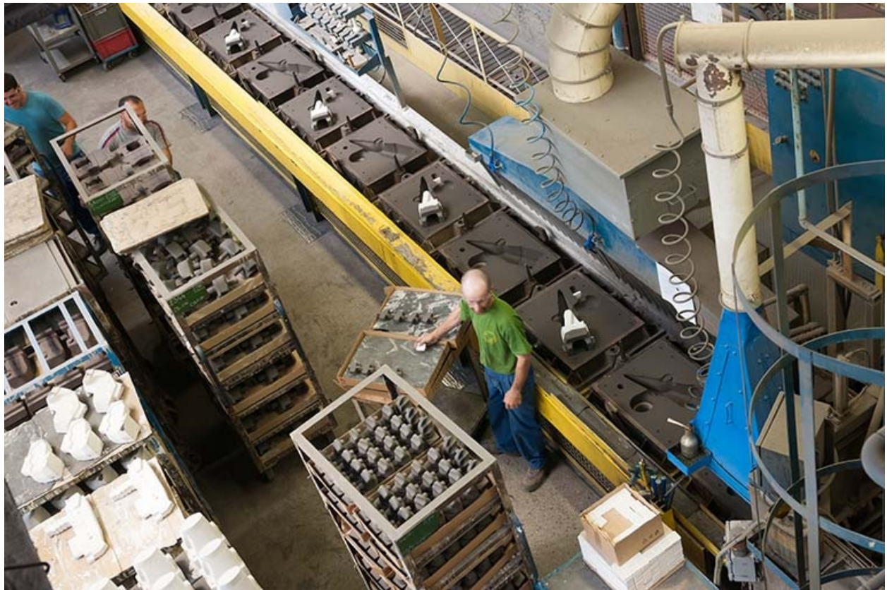
Montage des moules (2).
