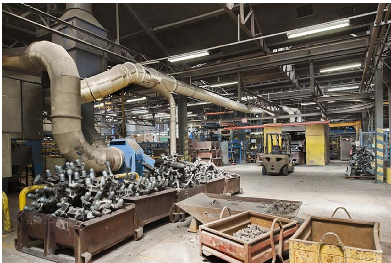
Pièces en sortie de ligne de moulage.
