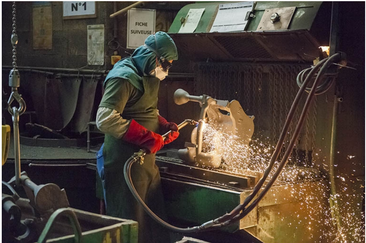
Découpage de pièces au chalumeau (2).
