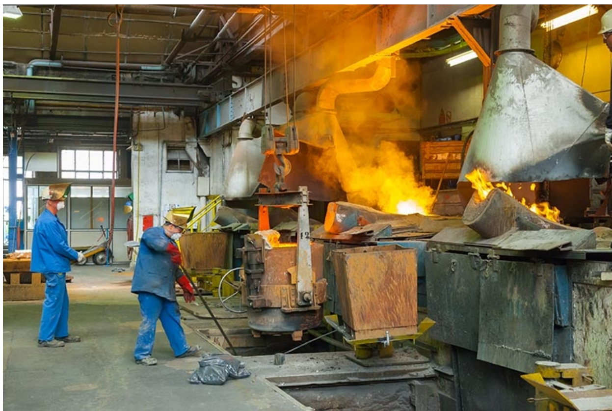
Fours à induction. Préparation d'une coulée.
