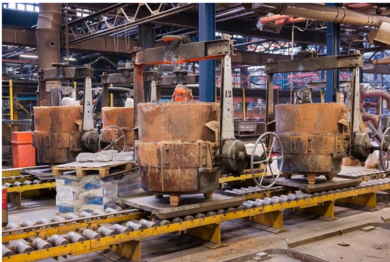
Poches de coulée avant réfection (2).
