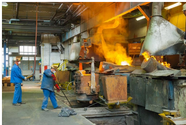
Fours à induction. Préparation d'une coulée. Phot. Jérôme Mongreville IVR43_20132500954NUC4A
