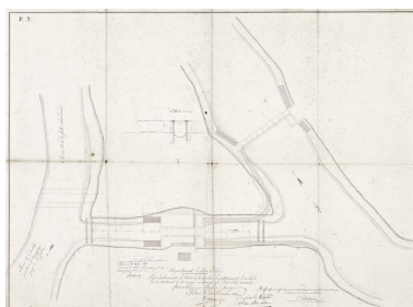
"Projet d'exhaussement de l'écluse de la Truchère et du perfectionnement de ses abords et du rattachement de cet ouvrage au barrage qui vient d'être construit" par l'ingénieur Delarue, le 20 décembre 1824. Vue d'ensemble. 1824. (Archives VNF-direction territoriale Centre-Bourgogne ; subdivision de Montceau-les-Mines) Phot. Jean-Luc Duthu, Autr. Delarue IVR26_20120100017NUC2A
