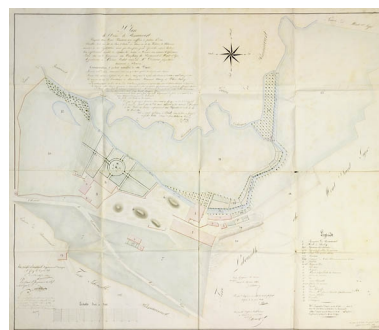
Plan de l'usine de Renaucourt composée d'un haut fourneau avec soufflerie à pistons, de 2 patouillets [...], appartenant à Mme Rochet veuve de M. Dornier. Phot. Jérôme Mongreville, Phot. Guyet IVR43_20097000054NUC2A
