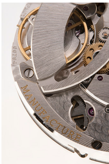
Face côté fond : détail du balancier-spiral et inscription. Phot. Sonia Dourlot IVR43_20182501181NUC4A
