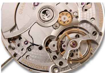
Face côté fond : balancier- spiral et inscriptions. Phot. Sonia Dourlot IVR43_20182501183NUC4A
