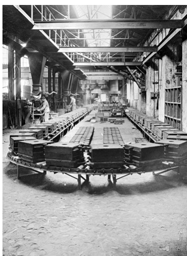
Fonderie : carrousel pour le moulage des grilles de résistance. Phot. IVR43_20029000180X
