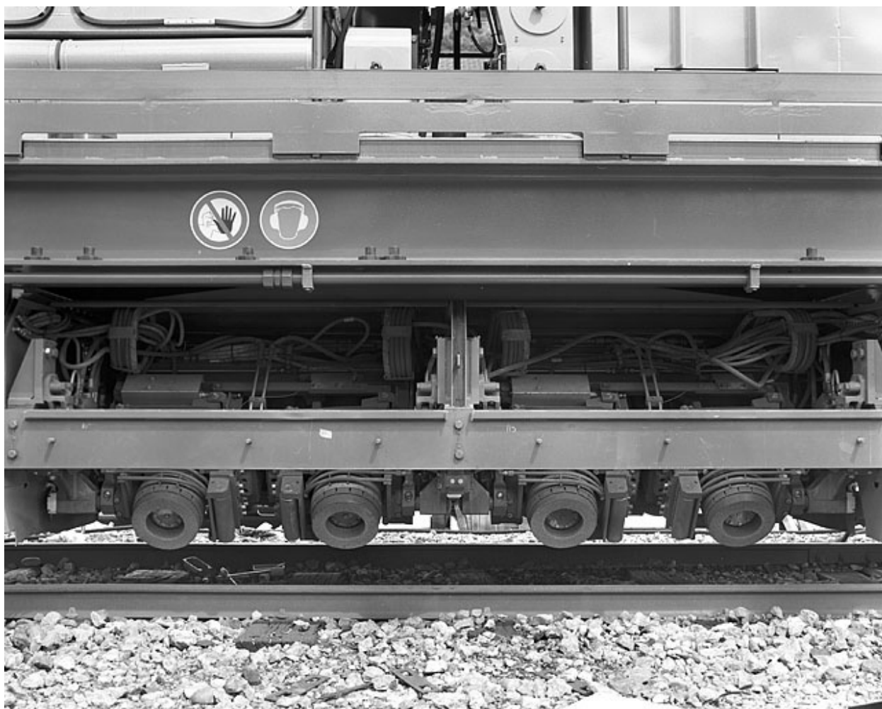
Train de meulage : système de meulage.
