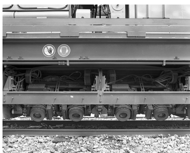
Train de meulage : système de meulage. Phot. Yves Sancey IVR43_20053900925X
