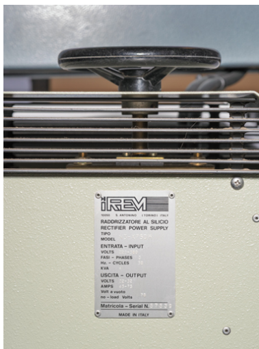
Plaque signalétique du redresseur IREM. Phot. Pierre-Marie Barbe-Richaud IVR26_20257100180NUC4A
