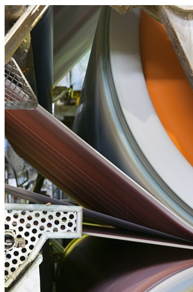
Passage de la feuille de papier entre les cylindres de pressage et d'égouttage. Détail. Phot. Jérôme Mongreville IVR43_20122500983NUC4A
