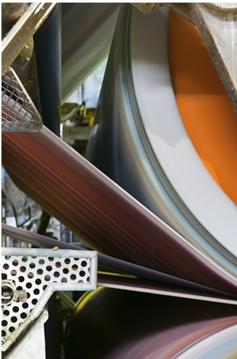
Passage de la feuille de papier entre les cylindres de pressage et d'égouttage. Détail.
