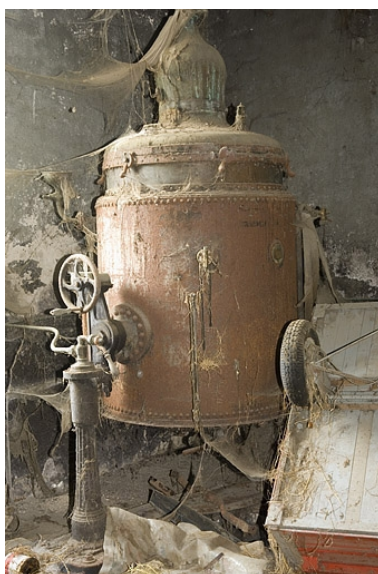
Atelier de distillation. Alambic Egrot et Grangé. Phot. Jérôme Mongreville IVR43_20067000678NUCA
