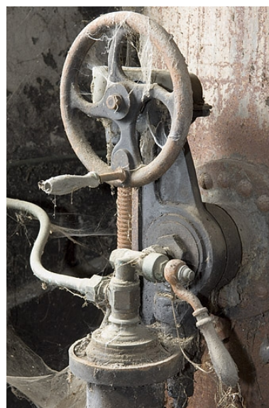
Atelier de distillation. Alambic Egrot et Grangé. Volant du mécanisme de bascule. Phot. Jérôme Mongreville IVR43_20067000679NUCA
