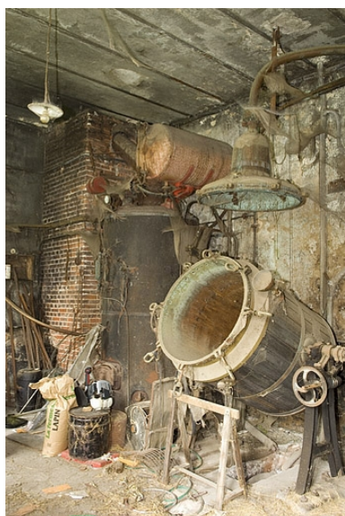
Atelier de distillation : base de la cheminée, chaudière et alambic Egrot et Grangé. Phot. Jérôme Mongreville IVR43_20067000676NUCA
