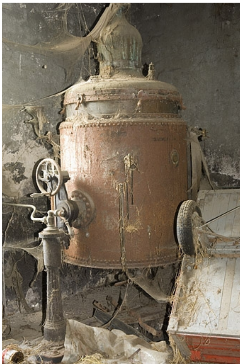
Atelier de distillation. Alambic Egrot et Grangé.
