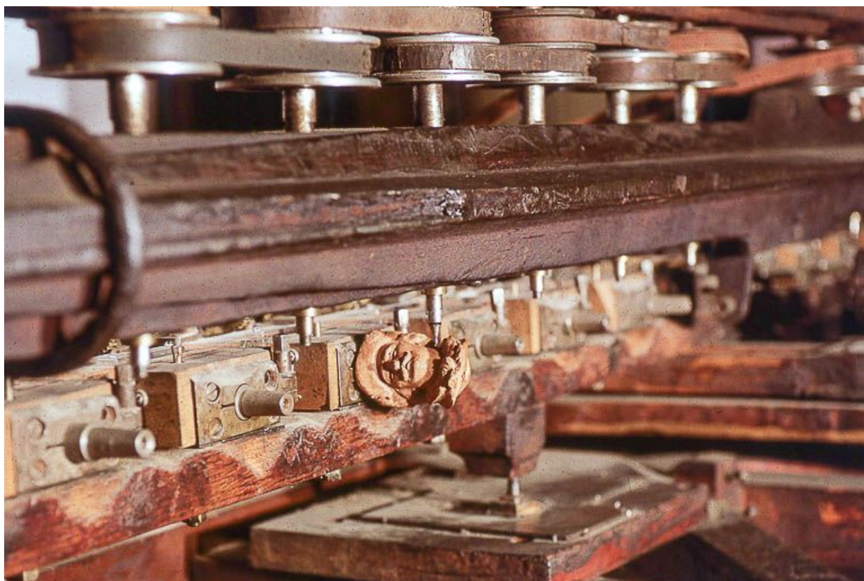
Face arrière : ébauchon sculpté et fraise de finition.
