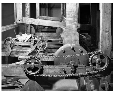
Face latérale droite. Aux premier et second plans, système de renvoi par chaîne permettant la rotation simultanée du modèle et des ébauchons. Phot. Jérôme Mongreville IVR43_20003901209V
