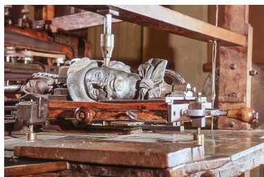
Modèle (d'Artagnan) et son support mobile, vus de trois quarts avant gauche. Manœuvré à l'aide des poignées, le support glisse sur une plaque métallique, chaque détail du modèle pouvant ainsi être retransmis par le palpeur vertical. Phot. Jérôme Mongreville IVR43_20003901201ZA
