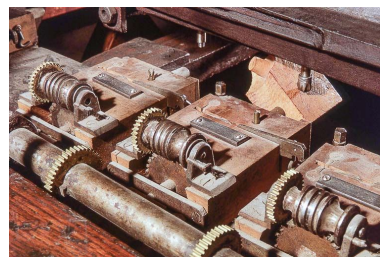
Face arrière : engrenages permettant la rotation simultanée des ébauchons. Phot. Jérôme Mongreville IVR43_20003901190ZA
