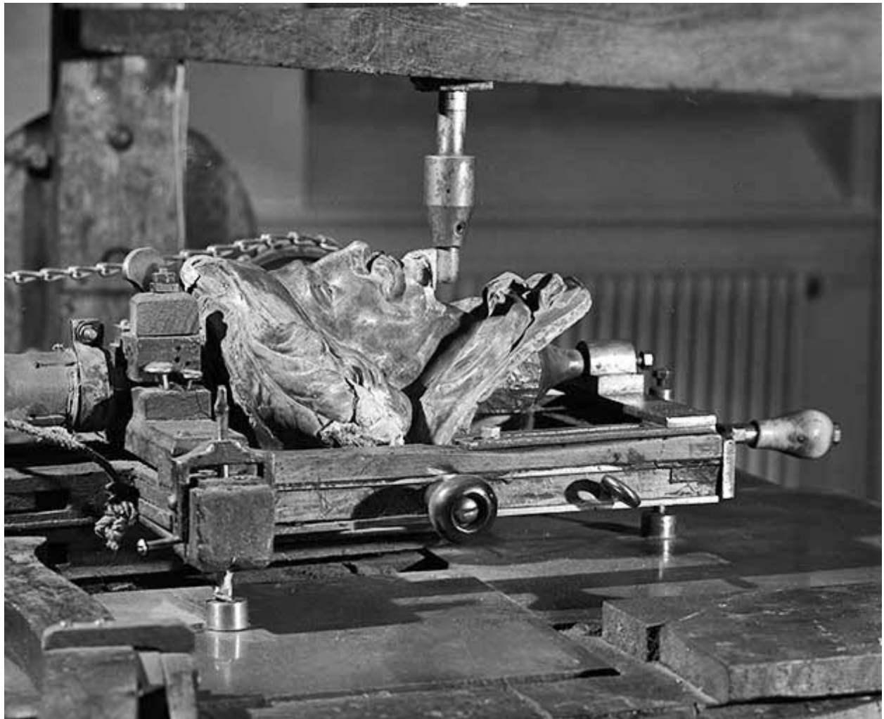
Modèle (d'Artagnan) et son support mobile, vus de trois quarts arrière gauche. Manoeuvré à l'aide de poignées, le support glisse sur une plaque métallique, chaque détail du modèle pouvant ainsi être retransmis par le palpeur vertical.
