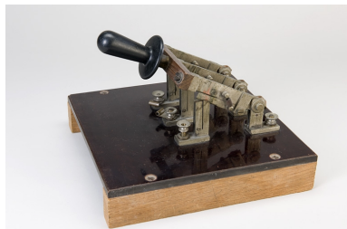
L'interrupteur fermé. Phot. Marc Loukachine IVR43_20122500011NUC4A
