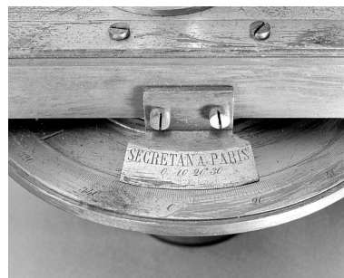
Détail du cercle et de la vis tangente gradués, portant le nom du fabricant. Phot. Jérôme Mongreville IVR43_20032500720X
