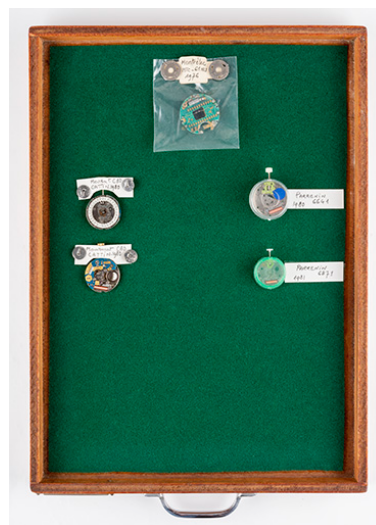
Modules à quartz étudiés par le Cetehor dont, en haut, un Montrelec MTC-61 NU (1976). (Collection Cetehor, Besançon). Phot. Sonia Dourlot IVR43_20192500305NUC4A
