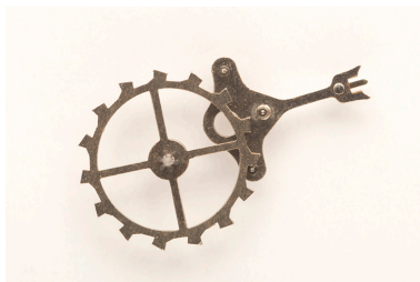
Roue d'ancre et ancre à chevilles.
