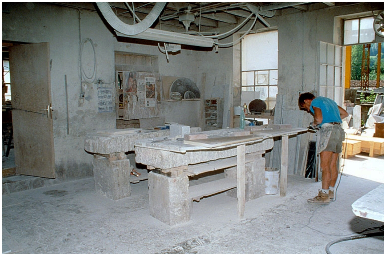
Balanod, marbrerie Yelmini Artaud : polissage du chant d'une marche d'escalier à l'aide d'une meuleuse.
