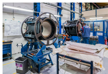
Atelier de bobinage. Montage des barres de cuivre. Phot. Jérôme Mongreville IVR43_20162500158NUC4A
