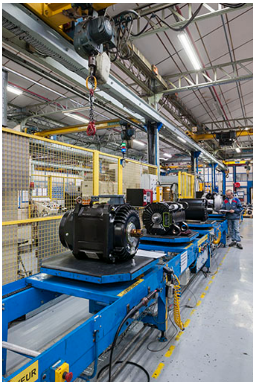
Atelier de finition. Moteurs en préparation.
