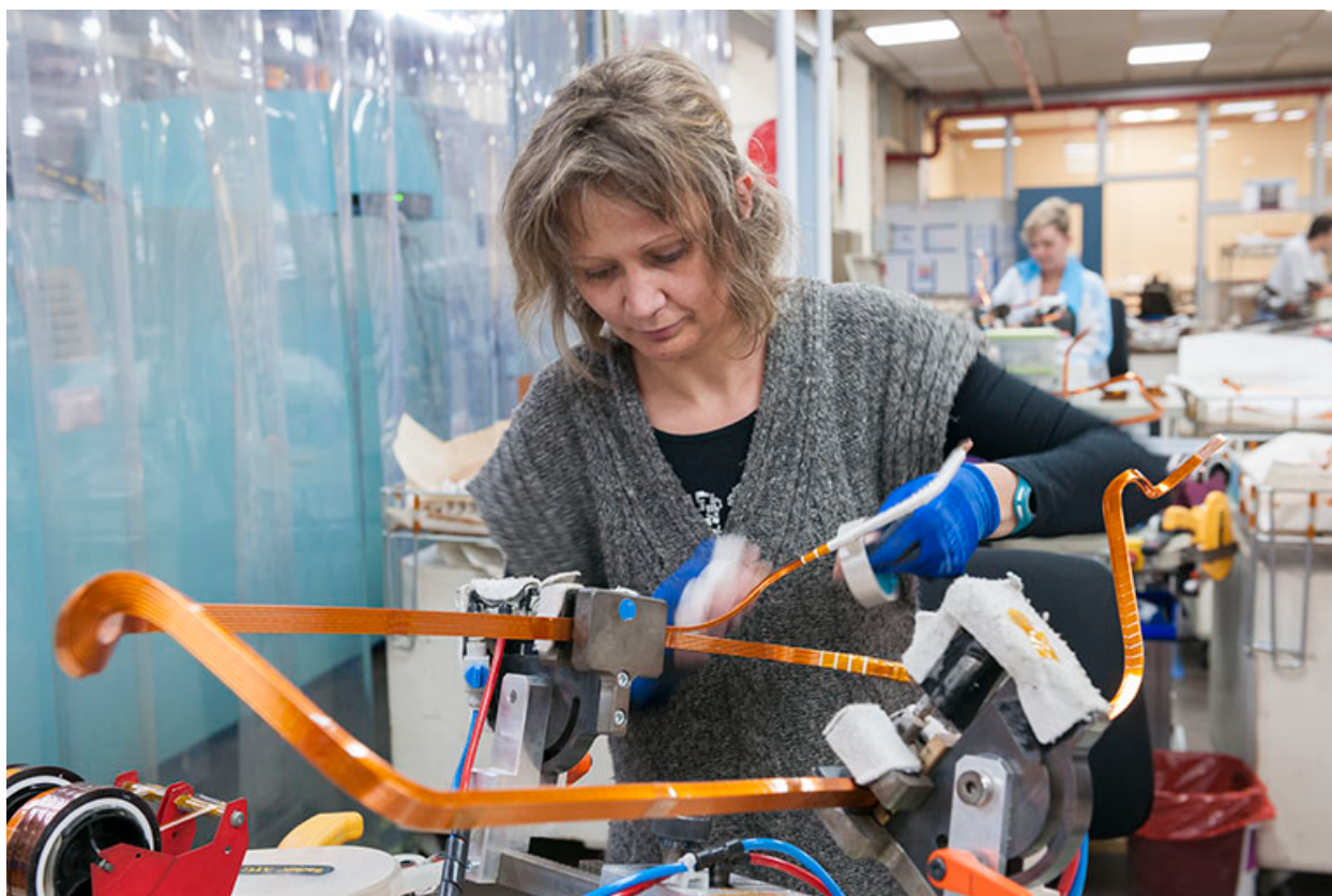
Isolation manuelle des barres de cuivre.
