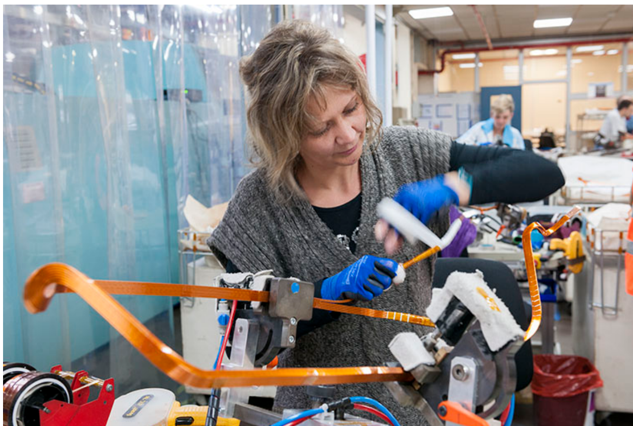
Isolation manuelle des barres de cuivre.
