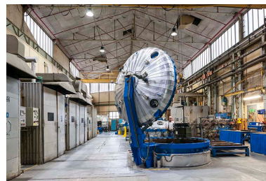
Atelier d'imprégnation (autoclave ouvert). Phot. Jérôme Mongreville IVR43_20162500169NUC4A
