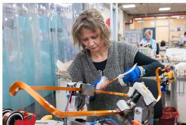
Isolation manuelle des barres de cuivre. Phot. Jérôme Mongreville IVR43_20162500181NUC4A
