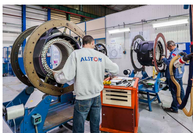
Atelier de bobinage. Montage des barres de cuivre sur les stators. Phot. Jérôme Mongreville IVR43_20162500168NUC4A
