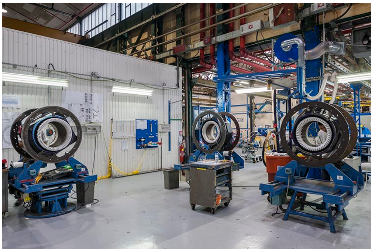
Atelier de bobinage. Equipement des stators.
