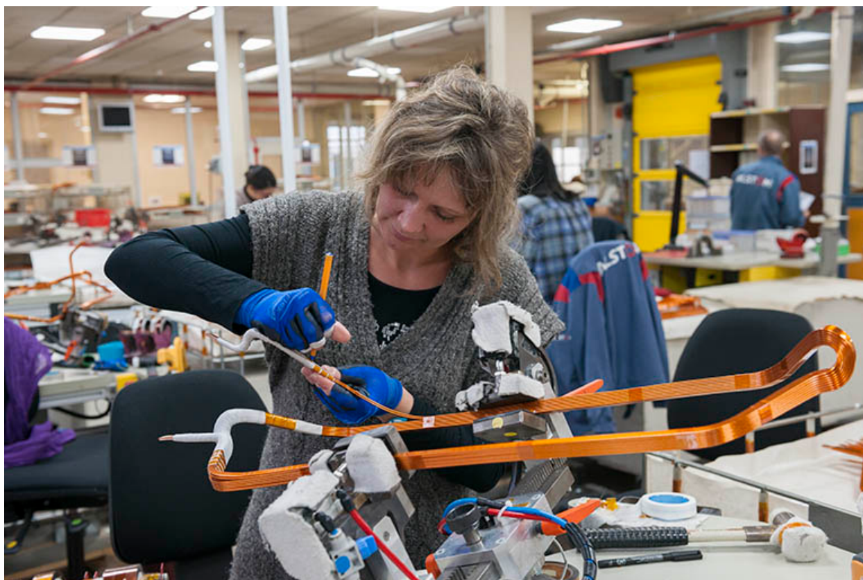
Isolation manuelle des barres de cuivre.
