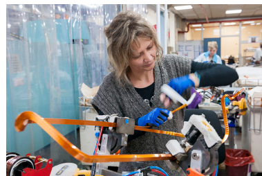
Isolation manuelle des barres de cuivre. Phot. Jérôme Mongreville IVR43_20162500182NUC4A
