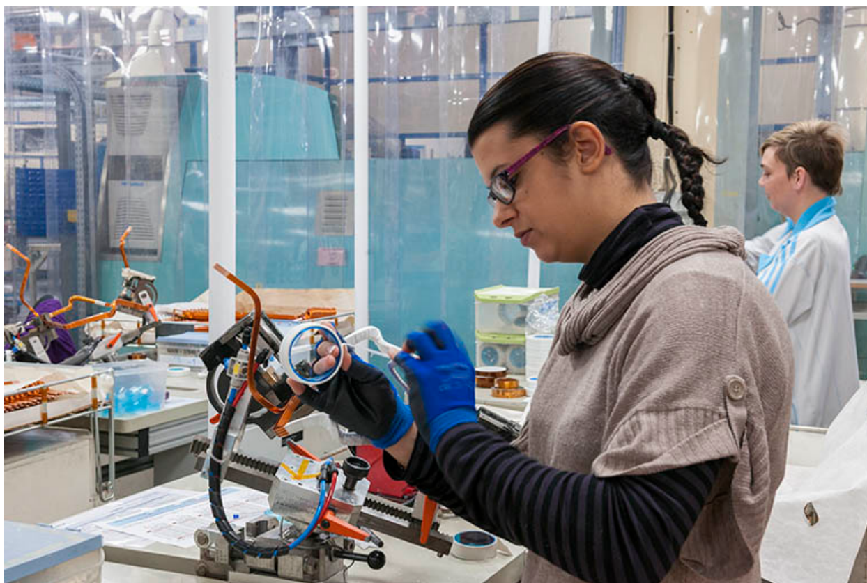
Isolation manuelle des barres de cuivre.
