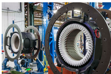
Atelier de bobinage. Stators équipés de barres de cuivre. Phot. Jérôme Mongreville IVR43_20162500164NUC4A
