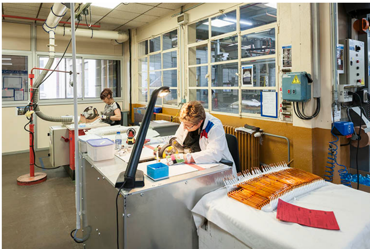
Isolation semi-automatique des barres de cuivre.
