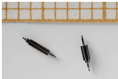
Exemples de composants fabriqués dans l'usine : pignons d'échappement.
