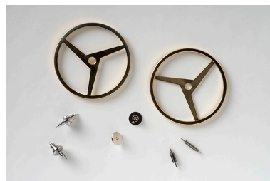
Exemples de composants fabriqués dans l'usine : serges et axes de balancier, plateaux et pignons d'échappement. Phot. Sonia Dourlot IVR43_20172500170NUC4A
