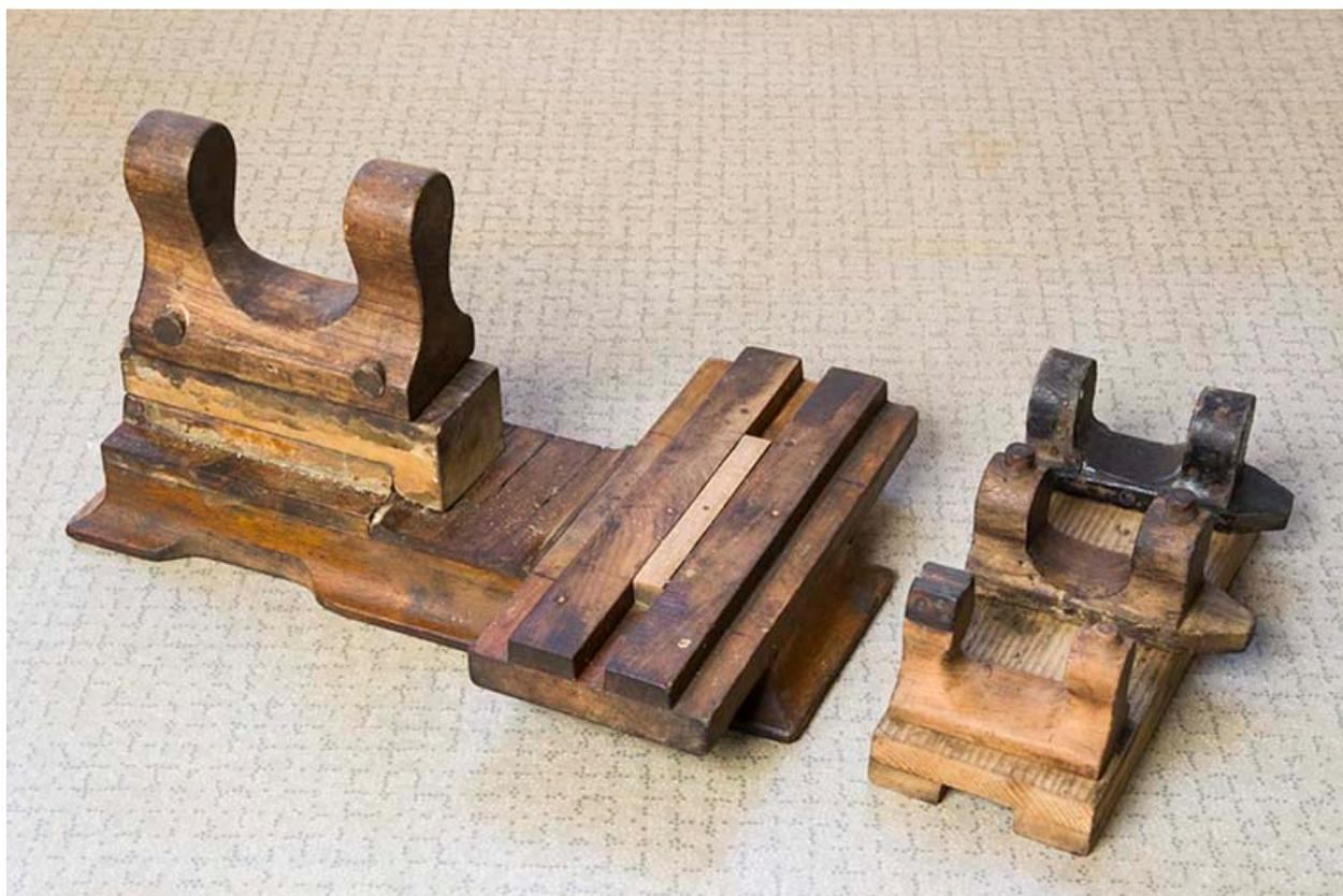
Exemple de production de l'atelier : modèle de fonderie en bois pour la fabrication d'une machine à pivoter.
