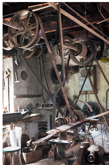
Affûteuse avec son mécanisme de transmission.
