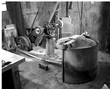
Machine à polir (meule du module de polissage des plinthes). Phot. Yves Sancey IVR43_19933900361X
