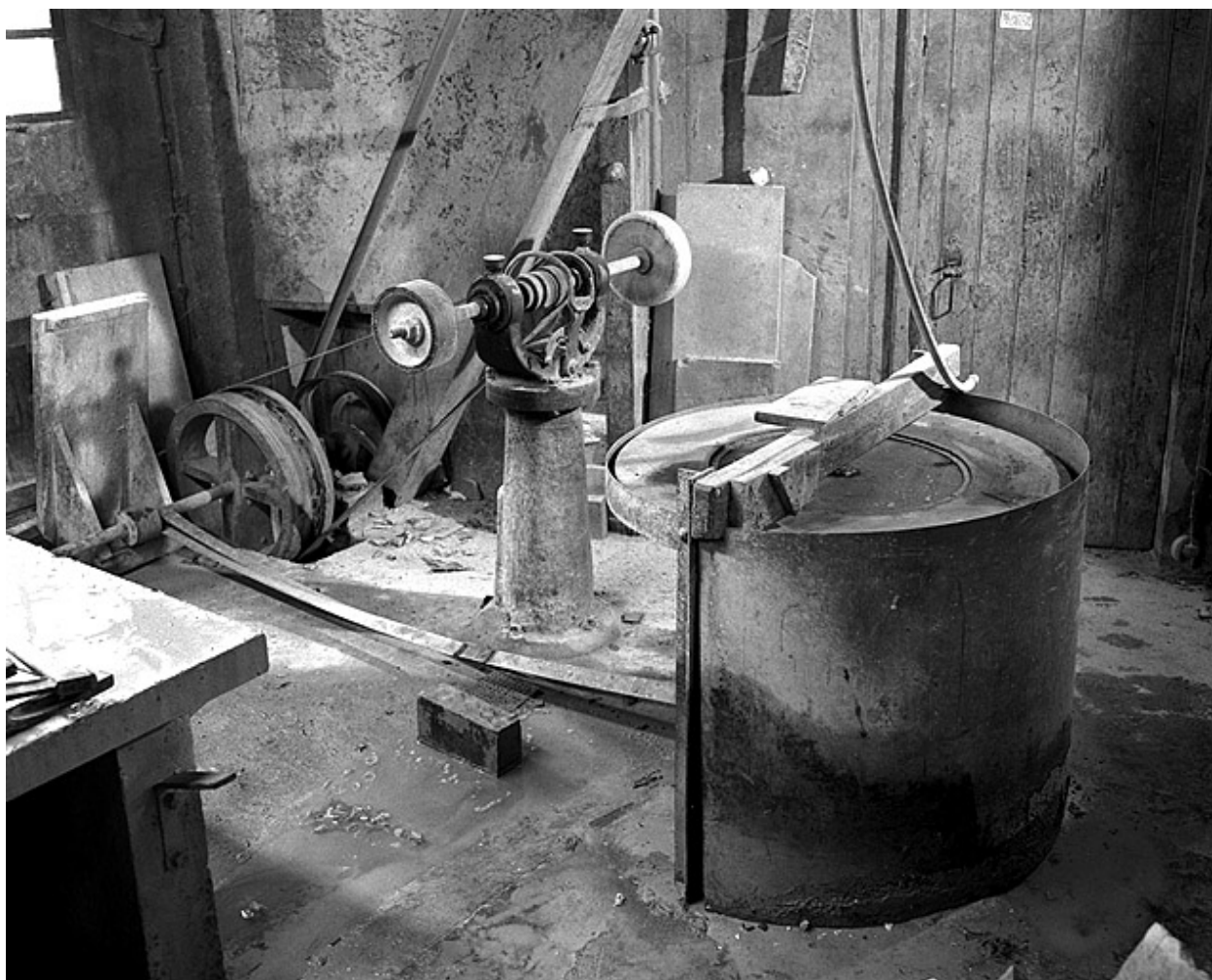
Machine à polir (meule du module de polissage des plinthes).
