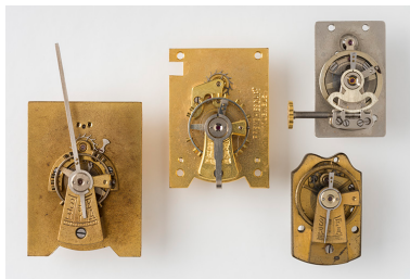
Face supérieure des quatre porte-échappements. De gauche à droite : 2e et 3e porte-échappements, 4e (en haut) et 1er (en bas). Phot. Sonia Dourlot
