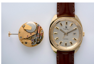
Montre-bracelet électromécanique dite Lip Electronic, à côté d'un mouvement Lip R 184 vu côté ponts. Phot. Sonia Dourlot IVR43_20152502586NUC4A
