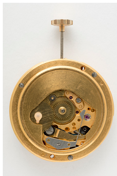
Mouvement de montre électromécanique Lip R 148, vu côté cadran. Phot. Sonia Dourlot IVR43_20152502568NUC4A
