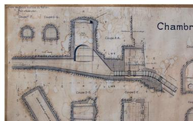
Société des Forces motrices du Refrain. Plan d'exécution. Chambre de mise en charge [détail : coupe longitudinale], 1908. Phot. Yves Sancey, Autr. Société des Forces motrices de l'Est IVR43\_20122502167NUC2A
