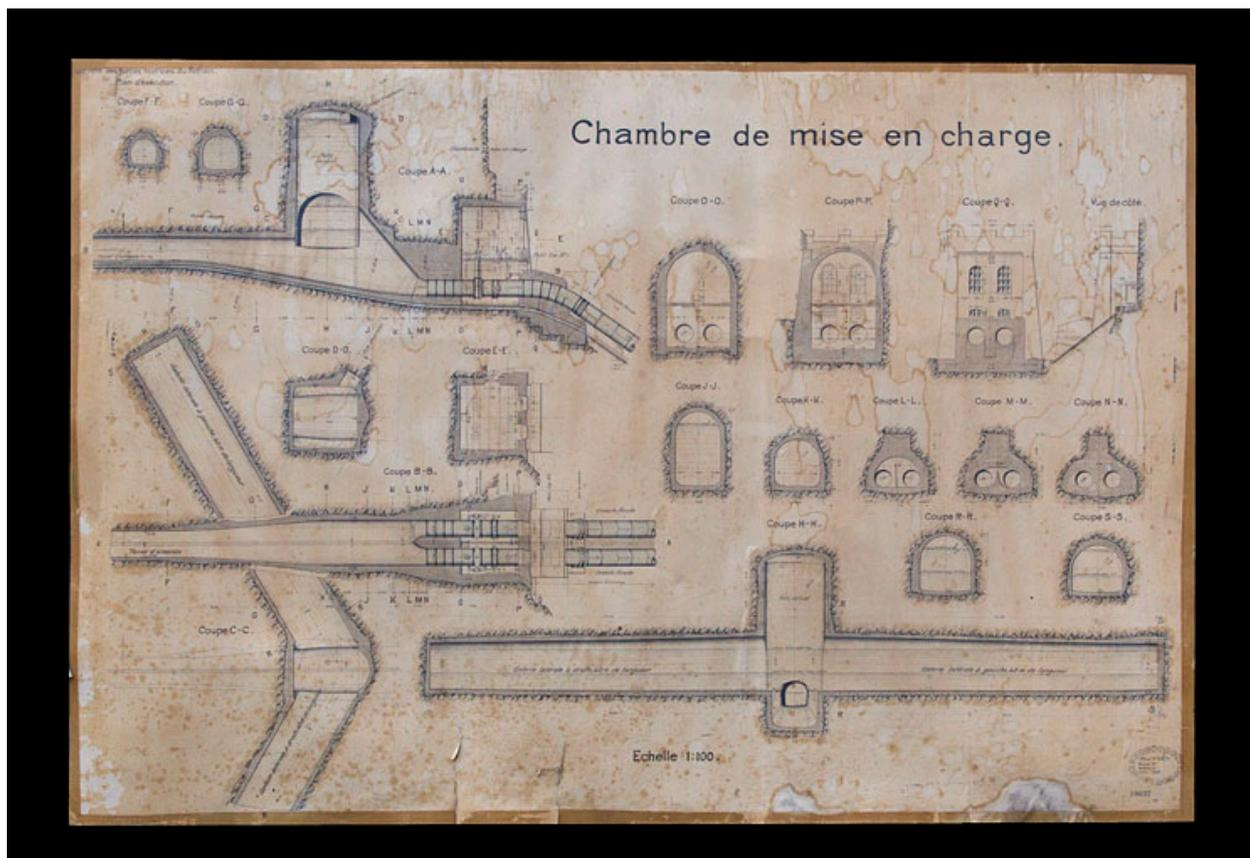
Société des Forces motrices du Refrain. Plan d'exécution. Chambre de mise en charge [plan et coupes], 1908.
