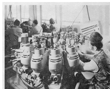
France Ebauches, une haute technicité. 3. Machine transfert 14 postes, réservée à la fabrication du calibre automatique, 1970. IVR43_20182501552NUC2A
