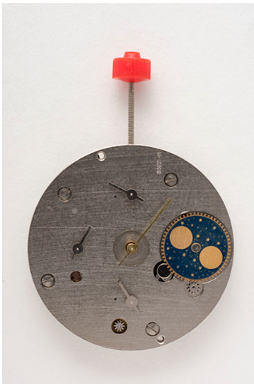
Module de montre à quartz France Ebauches FE 11500.
